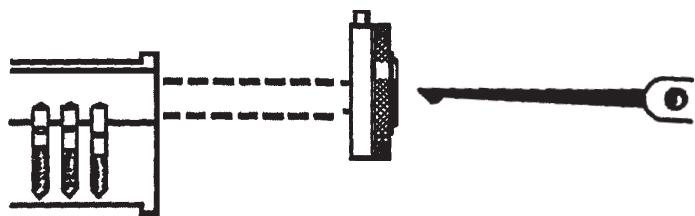
Za pomocą pierścienia TNT-20 powstaje w rdzeniu zamykającym napięcie skierowane w pożądany kierunku.
