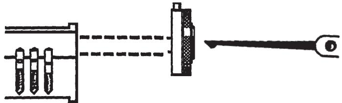
Es ist darauf zu achten, dass die Stifte des Spannwerkzeuges die Zuhaltungsstifte bzw. -scheiben des Schließzylinders nicht blockieren!
