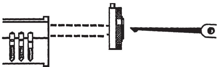
Avec l'outil TNT-20 on exerce une tension sur le bariillet (rotor) dans la direction souhaitée.
