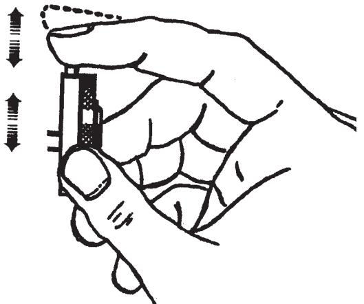
Um das Spannwerkzeug den in der Höhe verschiedenen Schließkanälen anzupassen, ist der obere Stift des Werkzeugs variabel und kann mittels des Druckknopfes, der sich oben auf dem Spannwerkzeug befindet, in der Höhe verstellt werden.
