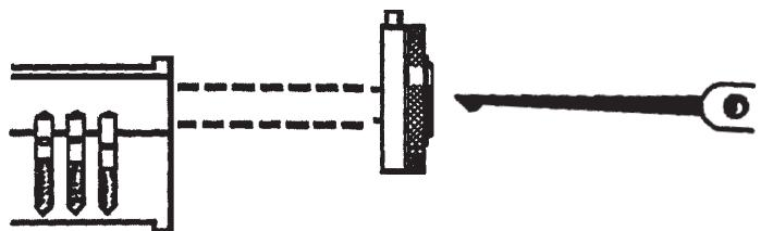
Con il tensore TNT-20, viene portato in tensione il nucleo del cilindro e teso nella direzione da noi desiderata.
