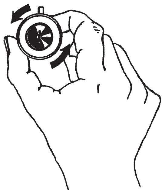
Il tensore TNT-20, é provvisto di 2 aghi. Questi 23 aghi, dovranno essere infilati all'interno della fessura del cilindro, il cuale vogliamo aprire.
