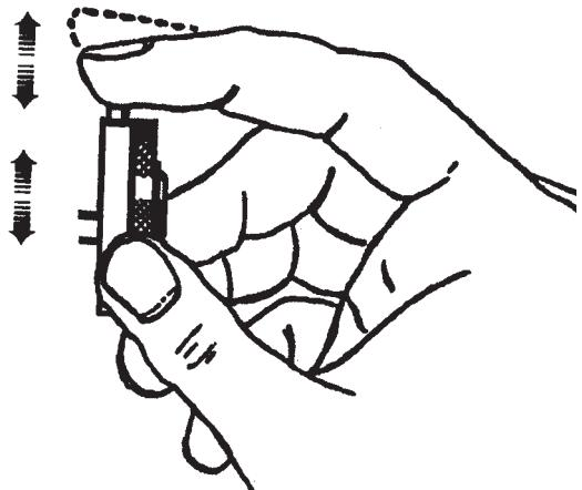
Należy przyłożyć pierścień TNT-20 do kanału zwierającego.
